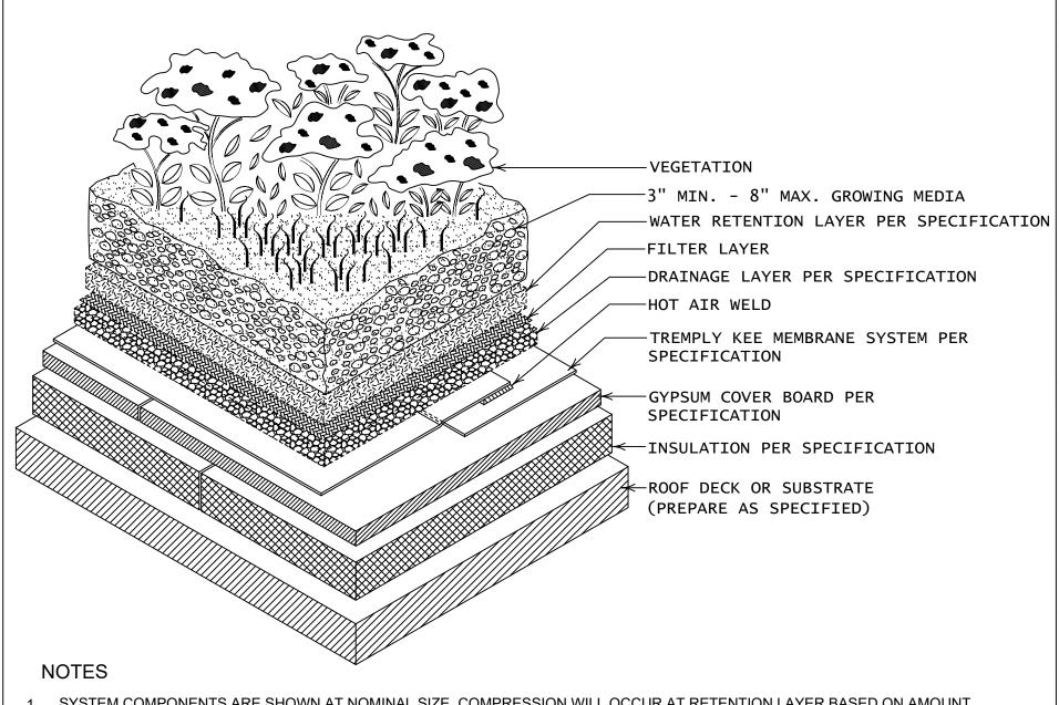
1. SYSTEM COMPONENTS ARE SHOWN AT NOMINAL SIZE, COMPRESSION WILL OCCUR AT RETENTION LAYER BASED ON AMOUNT (HEIGHT/VOLUME) OF GROWING MEDIA PLACED ON SYSTEM. MAXIMUM COMPRESSION
